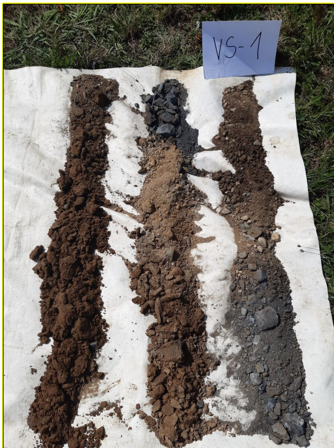
Obr. č. 1: Geologická dokumentace průzkumné sondy VS-1
